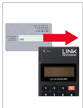
⑤ カードリーダー液晶に「カードを読み取ってください」と出力されたら、キャッシュカードを読み取る お客様に暗証番号を入力して頂き、「✓」ボタンを押下して頂く
